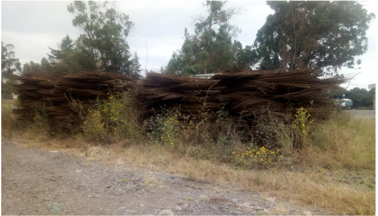
(በቃሊቲ የውጪ የብረት መጋዘን ብረት በሚባክንበትና ደህነቱ በሚጠበቅበት ሁኔታ ያልተቀመጠ መሆኑን የሚያሳይ ፎቶ ቁ.2)
