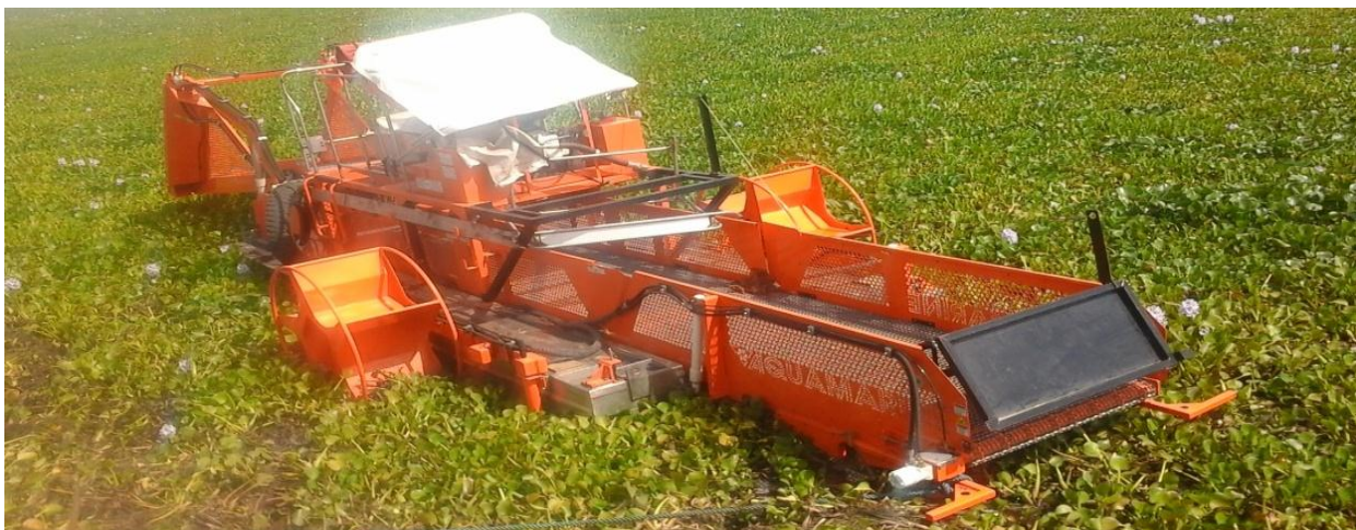
ምስል:-8 ከአለም አቀፍ የጣና ደህንነት ህብረት በእርዳታ የተሰጠ የእንቦጭ ማጨጃ ማሽን
