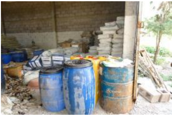
የተለያዩ አደገኛ ኬሚካሎች ወይም ጠንካራ አሲዶች (strog Acid) ሌብል ሳይደረጉ እና በየመጋዘን ቤቶች አንዱ ከለሌኛው ሳይለይ አጠገብ ላጠገብ ከተቀመጡት የሁለት ኢንዱስትሪ ለናሙና የቀረበ።
